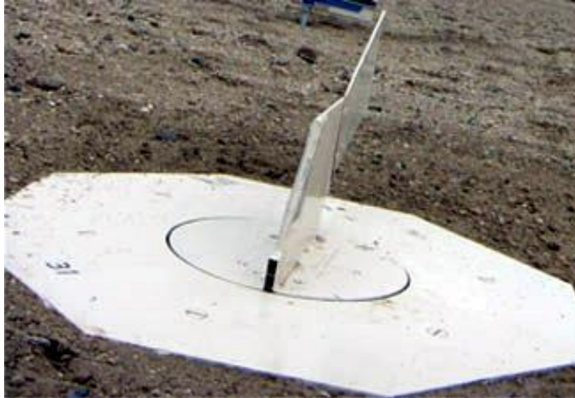
Fig. 6 Surface Creep Saltation sampler ( www.fryreardustsamplers.com )
