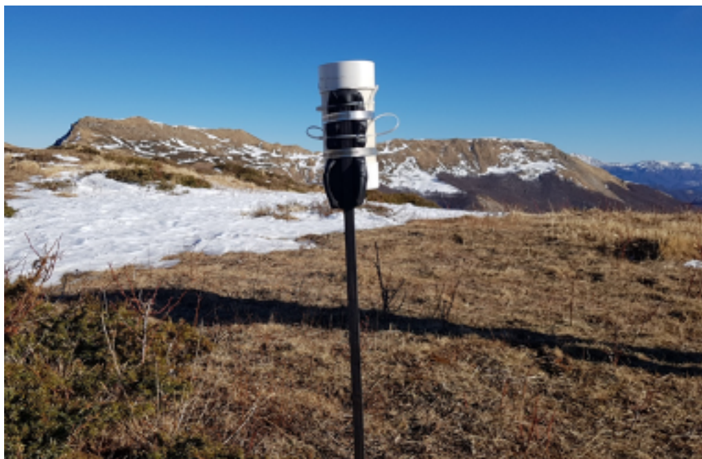
Figura 1. Sensore pancromatico denominato Sky quality o buiometro installato presso il rifugio Battisti di del CAI di Reggio Emilia
