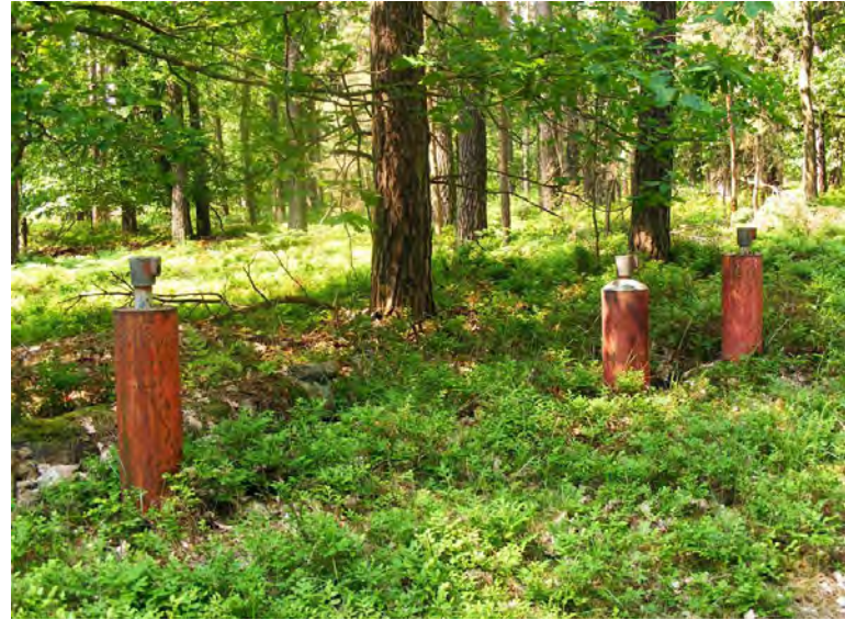
Abb. 20: Eine alte, bereits 1971 eingerichtete Grundwassermessstelle im Wald in der Nähe von Wokuhl (Foto: P. Stüve, Mai 2011).
