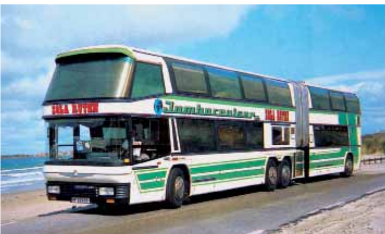
8. 1982 Sola Ruten Die nächste Designstufe mit wieder durchgehendem Überrollbügel, versenkten Scheibenwischern und schwarzem GFK-Stoßfänger verkörpert der norwegische Jumbocruiser.
