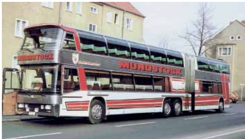
4. 1977 Mundstock Als alternative Motorisierung war ab 1977 der Mercedes-Benz OM 403 verfügbar, ein V 10 mit 235 kW (320 PS), er kam auch im Mundstock-Wagen zum Einsatz. Foto: Archiv Fa. Mundstock
