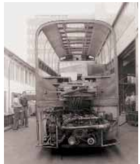
Hier ist nun die Vorderwagen-Heckpartie mit bereits eingebautem Motor und Nachläuferanbindung zu sehen.
